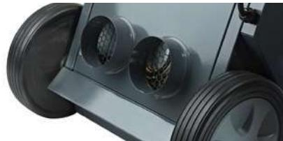
Velkosti 30S a 40S sú vybavené 1kW el. špirálou (pre zvýšenie výkonu) a vysokotlakovým ventilátorom umožňujúcim pripojenie dvoch flexibilných potrubí Ø100mm (max. 5m), pre cielený prívod odvlhčeného vzduchu
