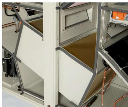
Vysokoúčinné rekuperátory vyrobené z hliníku a ošetrené epoxidovým náterom, extrémne odolné voči agresívному vlhkému vzduchu s obsahom chlóru.
