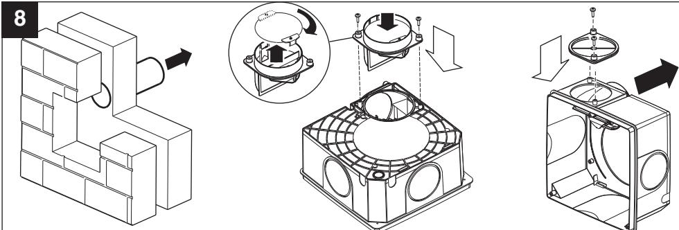
**IT** Su tre lati della scatola ad incasso sono previsti sfondamenti che consentono l'applicazione di un manicotto (in dotazione) di diametro nominale 75-80 mm per equipaggiare il prodotto con una presa d'aria supplementare da collegare, mediante un tubo, ad un secondo locale bagno, cantinetta, ripostiglio o altro.
